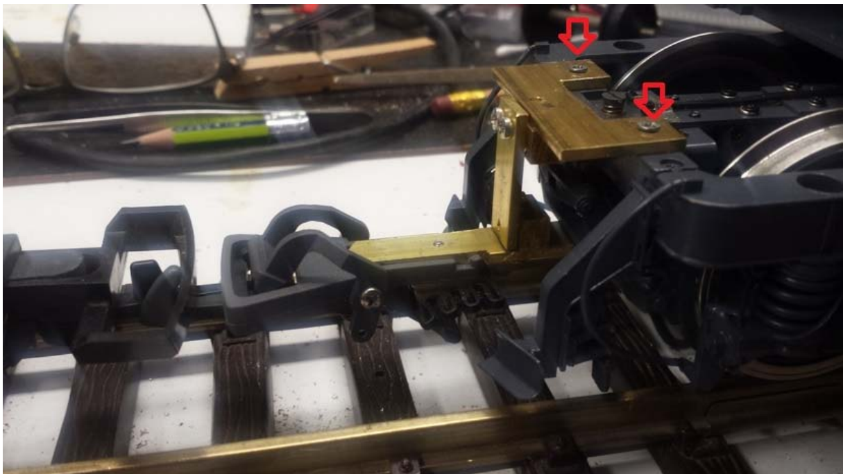
zur Befestigung nur zwei zusätzliche 2mm Gewinde, sonst komplett rückbaubar
