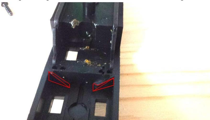
Jetzt geht es an den Motor und die Anpassung des Bühler-Motors. Die Anschlussprofile sind vom Piko-Motor abzulöten.
