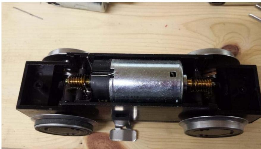
Zunächst wird das Getriebe komplett zerlegt, die Schleifer entfernt. Dann muss am Gehäuse und am Deckel Material abgetragen werden, da der Bühler-Motor etwas größer baut. Im roten Bereich ist eine Rundung auszuschleifen, im grünen Bereich einfach flächig Material abtragen.
