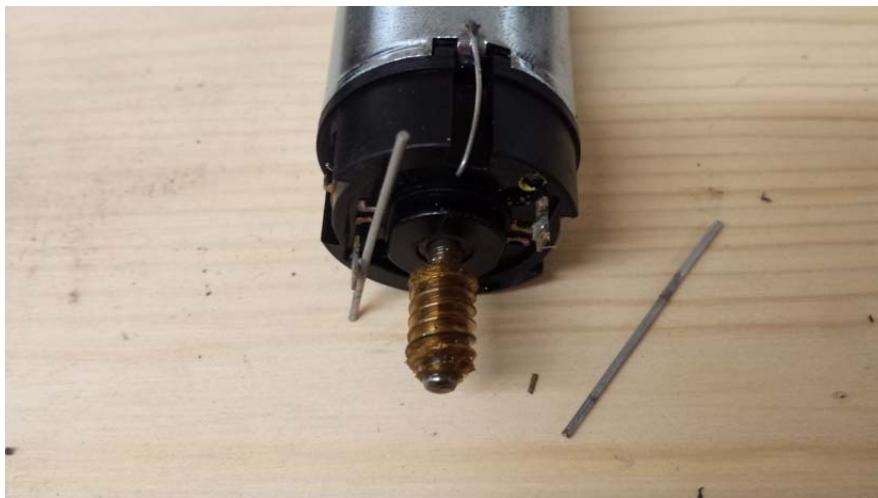
Die Anschlussprofile werden an die Anschlussfahnen des Bühler-Motors angelötet.
