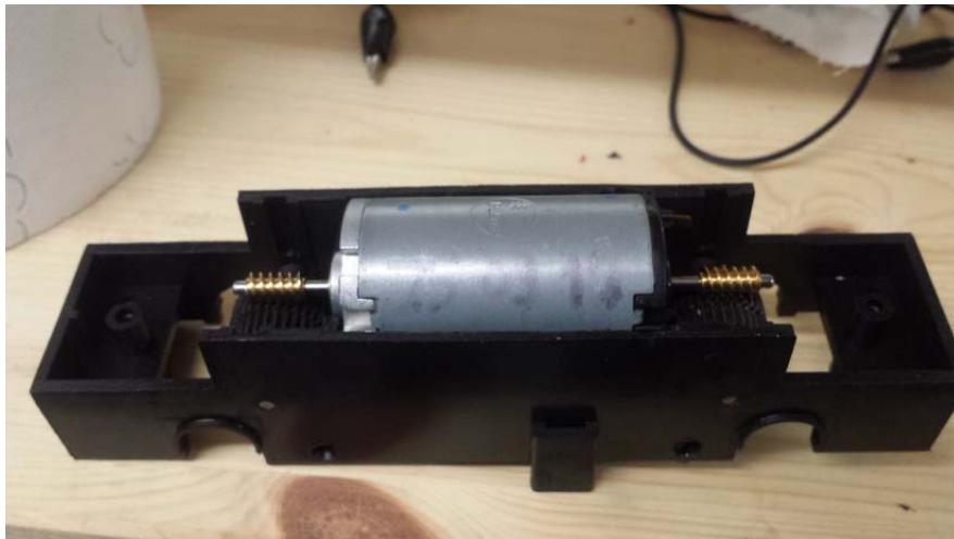
In der oberen Abdeckung wird das Gegenlager für den Motor ausgeschliffen. Im roten Bereich ist das Material abzutragen und eine Konkavität für die Motorrundung einschleifen.
