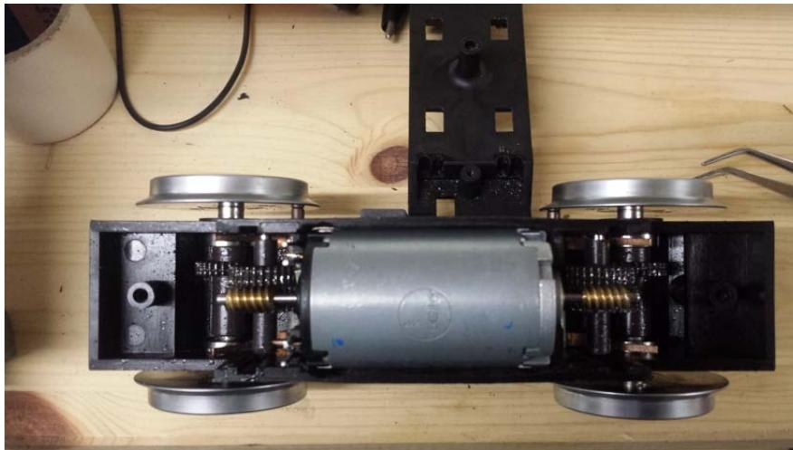
Zum Schluss muss die Anpassung der oberen Abdeckung erfolgen, die ja den Motor in der Halterung hält. Dazu einen Klebestreifen auf dem Motor anbringen, Heißkleber darauf und die obere Abdeckung aufdrücken.
