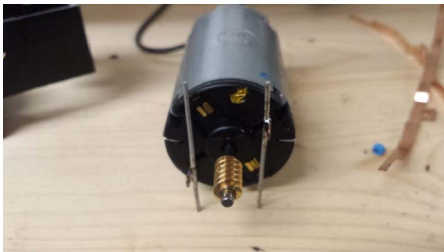
Im nächsten Schritt wird die Passung der Schnecke auf dem Zahnrad optimiert. Das Zahnrad unter der Schnecke sollte sich frei hin und her bewegen lassen. Die Schnecke sollte aber auch ausreichend in die Zähne eintauchen.
