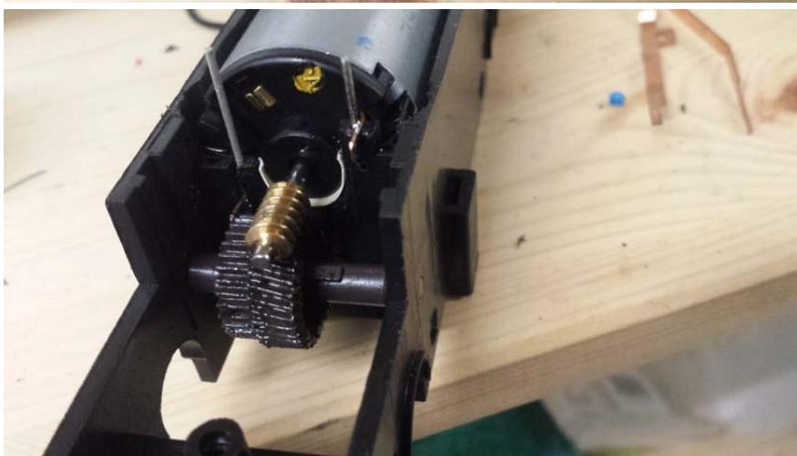
Zeit für den Kohleneinbau. Die Schleifkohlen (16mm) werden in die vorbereiteten 5mm Löcher gesteckt und an den Stromabnehmerfedern festgelötet.
