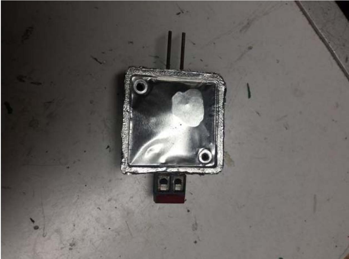
Somit ist der Wechsel der Dekodereinheit schnell möglich und auch der Dekoder selbst ist relativ rasch zugänglich und ausgelötet. Die Schraubenlöcher werden abgeklebt (Tesa Textil oder selbstklebende Alufolie).
