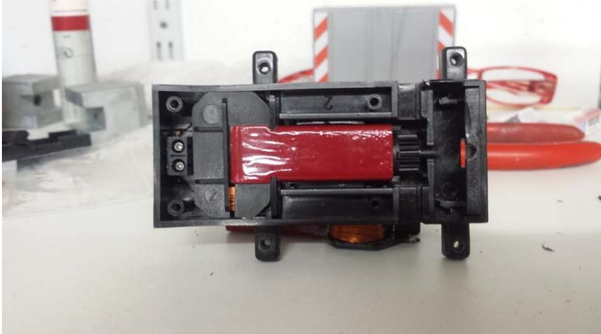
Anfänglich habe ich den Weichendekoder (Zimo MX 82x) im Gehäuse untergebracht. Das hat sich aber bzgl. Reparatur nicht so bewährt. Deshalb wird der Dekoder in einem separaten Gehäuse untergebracht (Gehäuse Hammond Conrad 535994).
