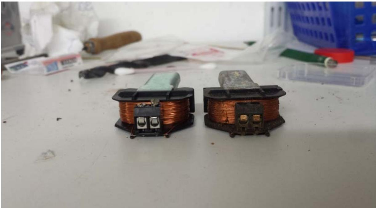
li. fabrikneue Schraubklemme – re. Klemme eingerostet, Schrauben sitzen fest
