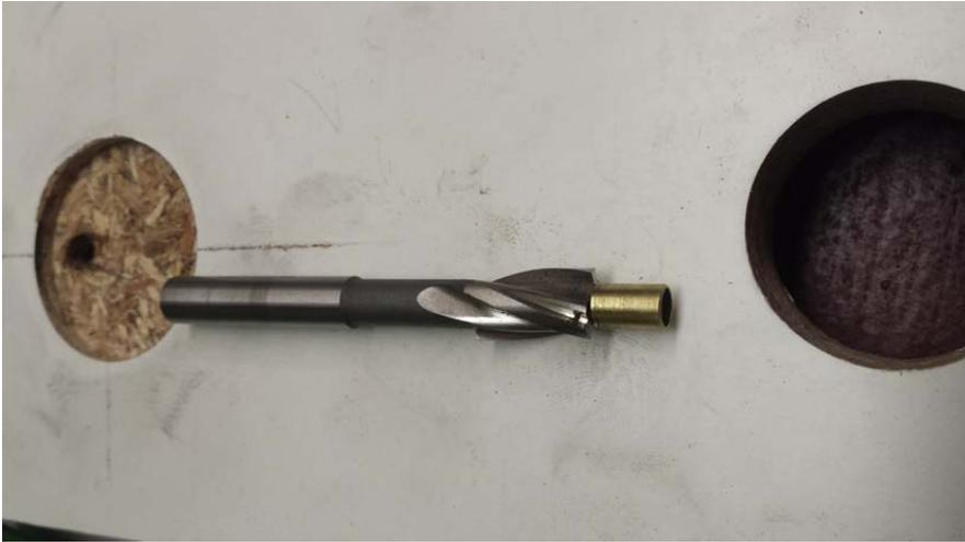
Zunächst wird der Getriebekörper mit dem 6mm Vorlauf zentriert.
