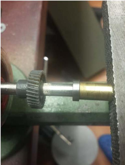
Die Aufweitung der Achsaufnahme auf die 10mm Kugellager gelingt am besten mit einer Standbohrmaschine mit fixierbarer Bohrgutaufnahme (Schraubstock). Eingesetzt wird ein sog. Flachsenker (10mm, vorne Bohrlochweite M5, darüber ein 6mm Rohrprofil)
