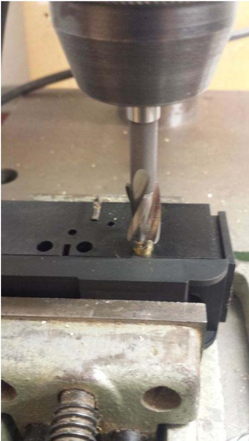
Anschließend mit dem Frästeil auf 10mm aufgebohrt
